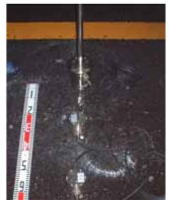
写真-1 小型 FWD の測定状況(橋軸直角方向)
