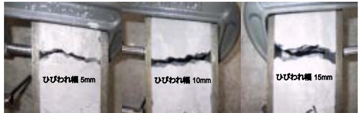
写真 - 1 各ひびわれ幅導入状況
