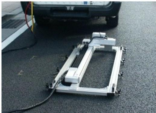
写真-1 レーザ式テクスチャメータ
