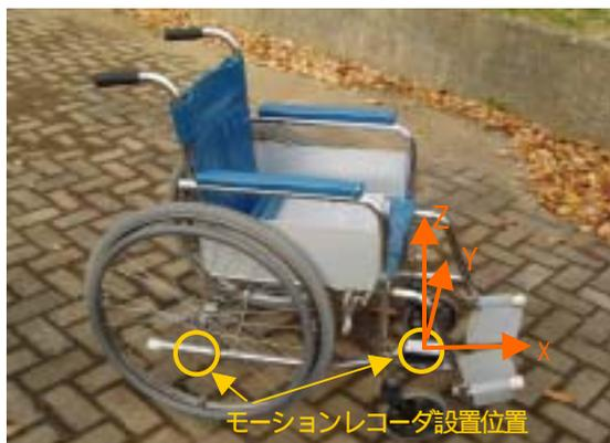
写真-1 測定に使用した車椅子と路面
