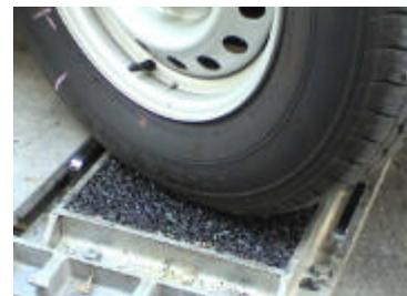
写真 - 1 実車据え切り試験状況
