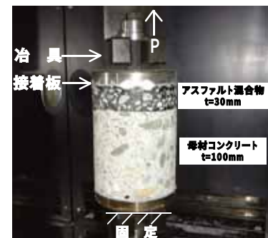
写真-1 直接引張試験の概要
