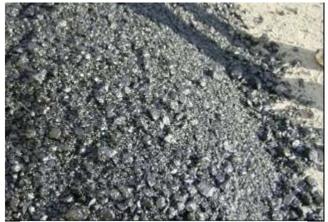
図－3 大粒径骨材を使用した排水性混合物
