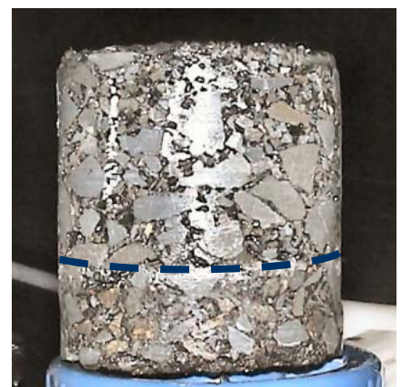
図－4 舗設後の抜き取りコア
