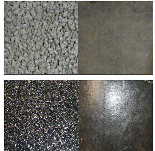
写真—1 排水性舗装(左)と密粒度舗装(右)の乾燥路面テクスチャ(上)と氷板路面(下)
