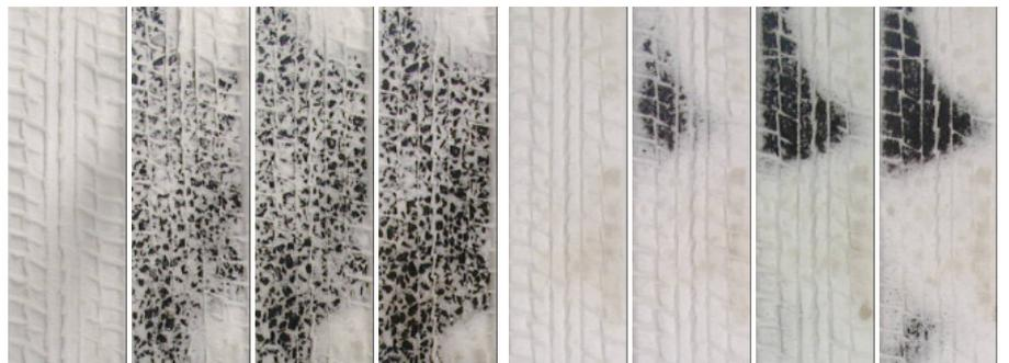
写真-3 湿り雪における排水性舗装(左)と密粒度舗装(右)の通過輪数増加に伴う雪氷消耗の過程
