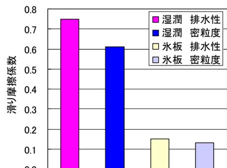
図—1 舗装による湿潤/氷板路面の滑りの違い
