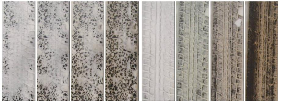
写真-2 乾き雪における排水性舗装(左)と密粒度舗装(右)の通過輪数増加に伴う雪氷消耗の過程
