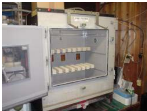
写真-1 耐排気ガス試験状況
