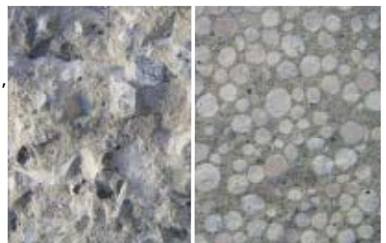
a) 普通コンクリート b) 真珠岩系軽量骨材コンクリート
