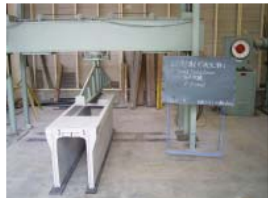
写真 - 1 製品の圧縮試験状況
