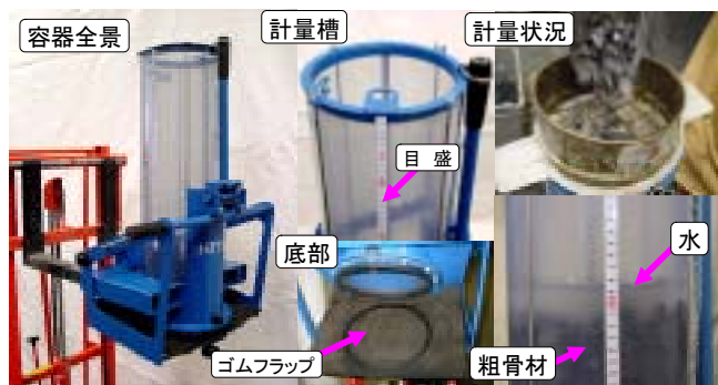
写真1 粗骨材の水浸式計量状況
