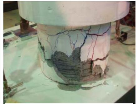
写真3 損傷状況(Case4, 8δy)
