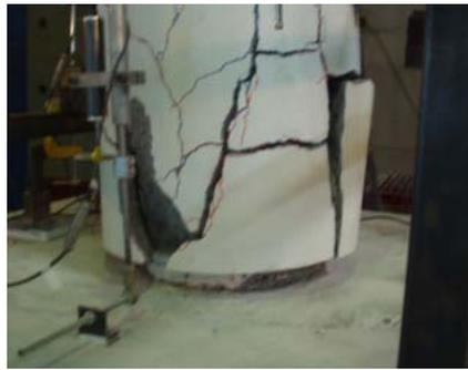
写真2 損傷状況(Case2, 8δy)
