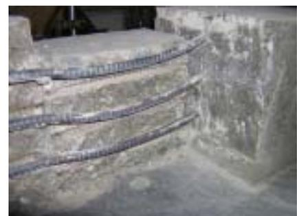
写真-2 RC-B の接合面
