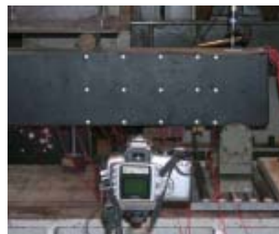
写真-1 非接触変位測定
