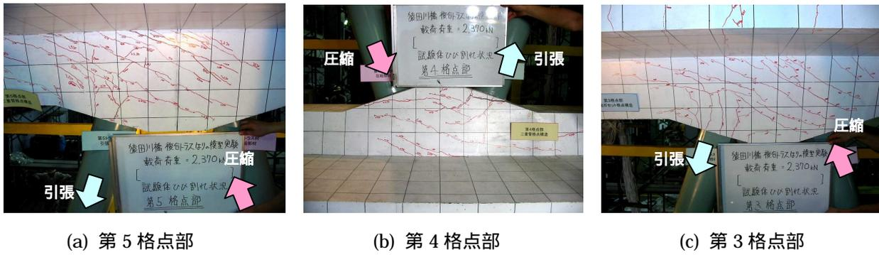
写真 - 1 格点部のひび割れ状況
