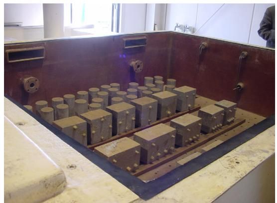
図-5 乾湿繰返実験の水槽
