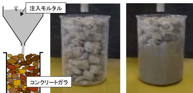
写真1 ガラの詰め込みおよびモルタル注入状況
