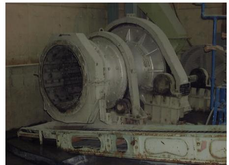
写真 - 1 製砂設備(ロッドミル)
