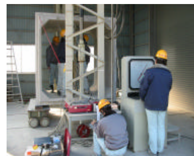
写真－1：試験体外圧試験状況
