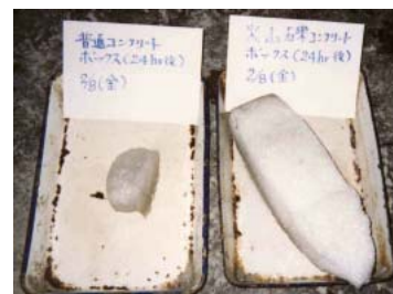
写真-3 24 時間後の残雪状況 (左：普通コンクリート 右：火山礫コンクリート)
