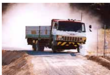
写真-1 大型車の実車衝突実験状況 (実験 2)
