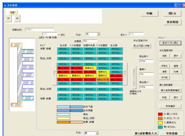
図-4 橋梁上部工の劣化程度判定例
