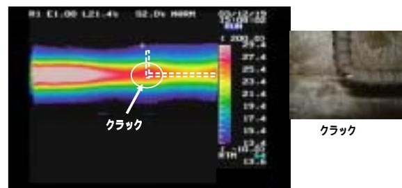
図-3 クラックの生じた鉄筋を配置した供試体の表面温度分布
