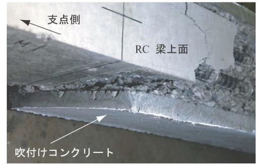
写真-1 M1 試験体の破壊状況
