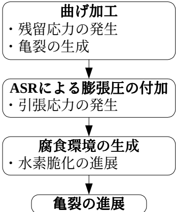
図－4 破断メカニズム
