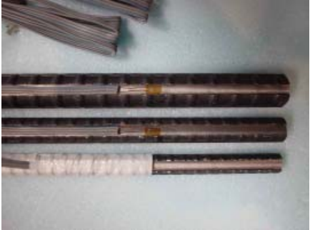
図－1 ひずみゲージ貼付け状況
