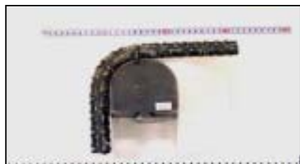
写真-3 曲げ半径測定状況
