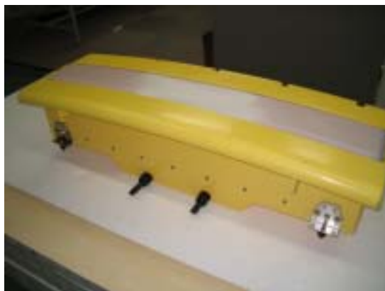
写真1： MLAレーダアンテナ （トンネル形状にあわせ、曲面 となっている）
