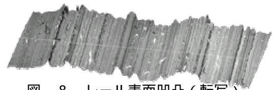
図 - 8 レール表面凹凸（転写）
