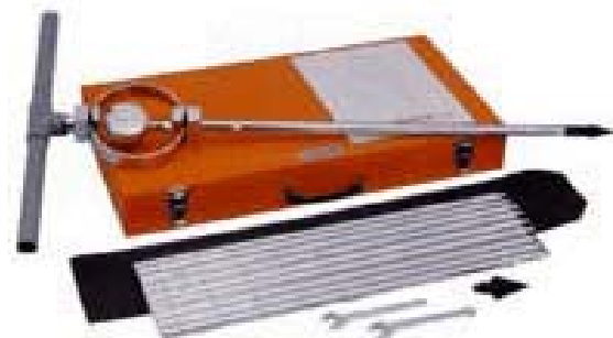
写真-1 コーン貫入試験器
