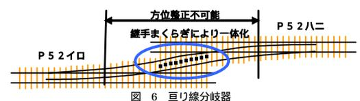
図 6 亘り線分岐器
