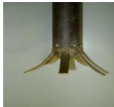
写真1 試験杭先端の拡底形状
