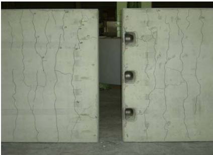
写真－ 2 正曲げ載荷終了後の供試体（複線金物 3 箇所）
