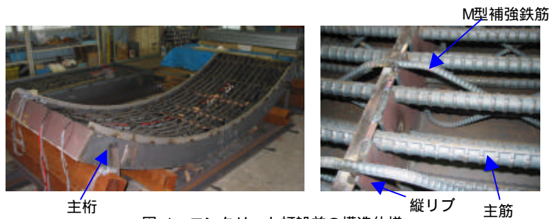
図-1 コンクリート打設前の構造仕様
