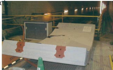
図1 実物 R C セグメントによる乾燥収縮ひずみの計測条件
