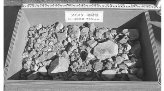
写真 - 2 破碎後(チェーン回転数 750rpm)
