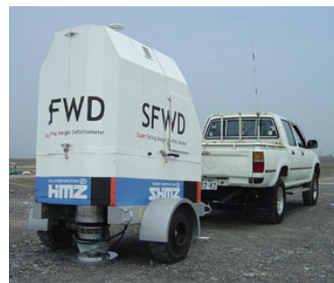
図-2 SFWDシステムの計測状況
