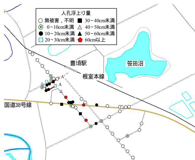
図 1 豊頃地区の人孔位置と浮上がり量
