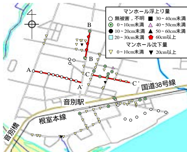
図1 音別町の人孔の被害概況及び断面位置図
