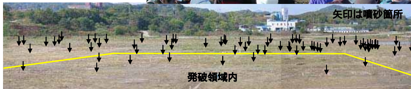
写真-1 噴砂発生状況（手前が発破領域内、噴砂中心の位置および径を測量。右上：2001 年当時の実験状況）
