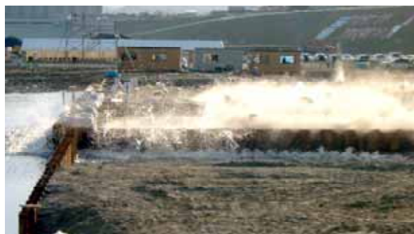
写真-1 人工液状化実験における発破状況
