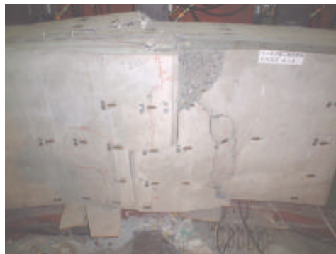
写真 - 3 再載荷最終状態 1 （補強内面，上面）
