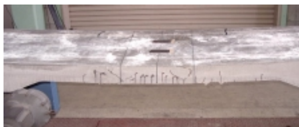
写真 - 2 載荷試験状況
