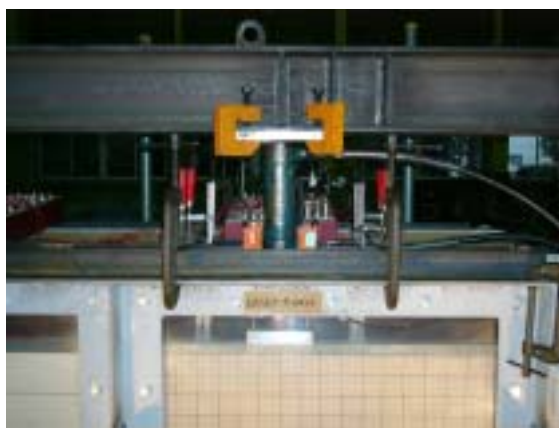
写真-1 鉛直載荷実験状況
