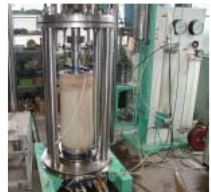
写真-1 大型三軸試験機
