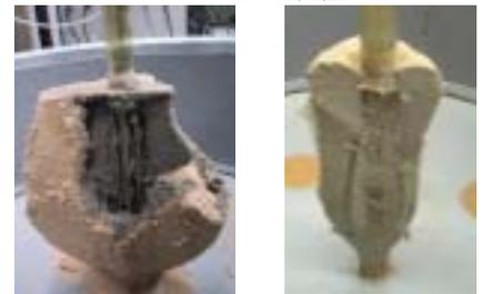
(a)応力制御注入機を使用 (b)ひずみ制御注入機を使用
