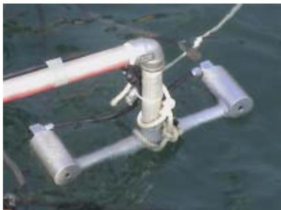
図 1 真珠養殖用M2-M型MB発生装置
