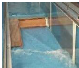
写真 1 魚道直下流での跳水
