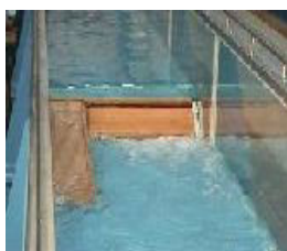
写真 3 堰直下流での跳水
