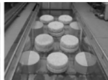
写真 4 20%勾配での溝型粗石魚道模型
